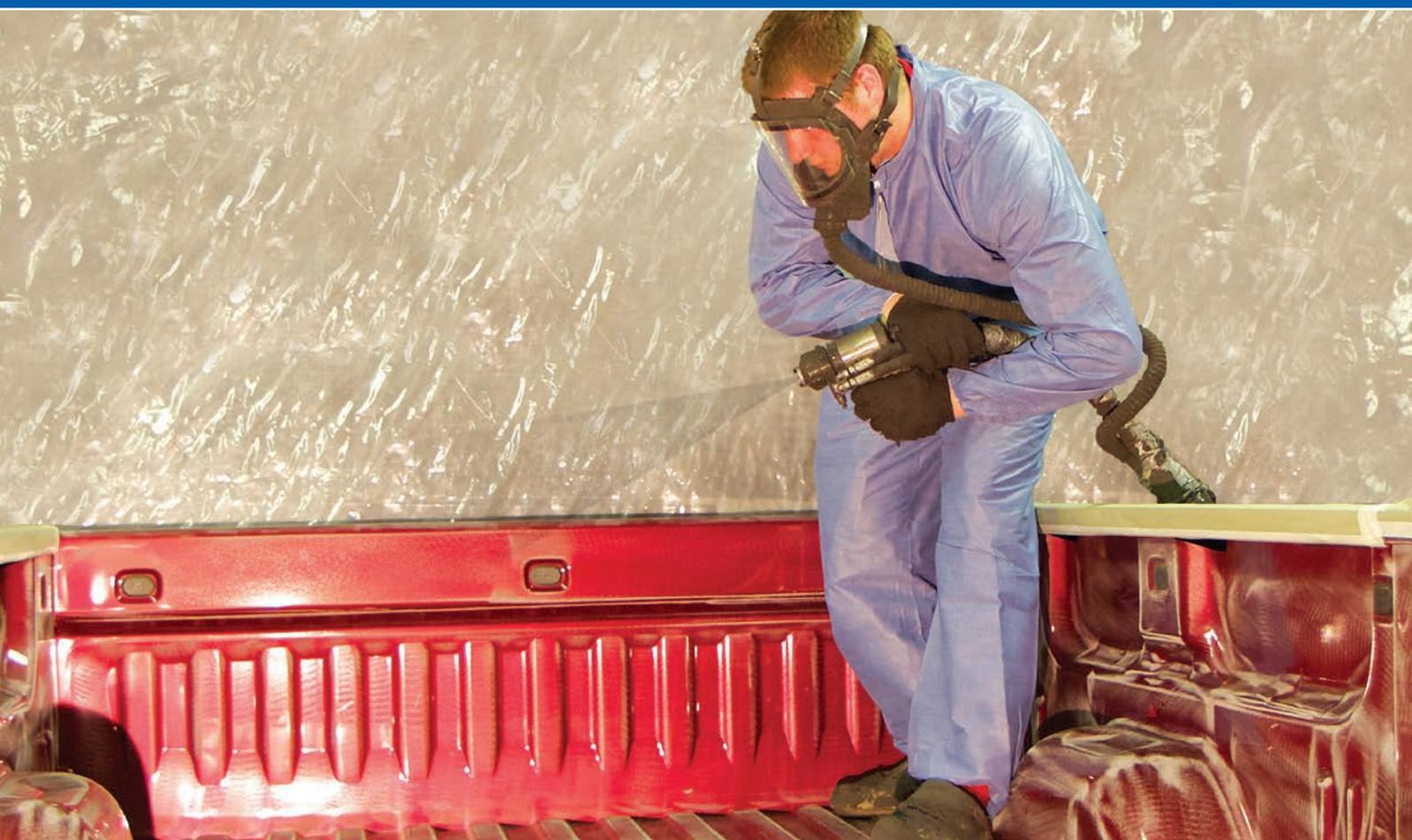
Система начального уровня, предназначенная для нанесения полимочевины и гибридной полимочевины
