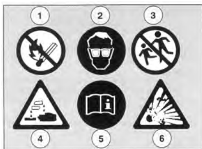
Предупреждающая наклейка на батарее
