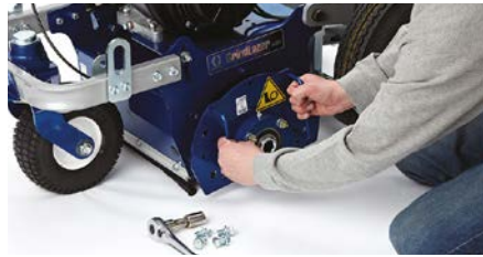
2. Удаление болтов и дверцы
