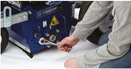
1. Откручивание четырех болтов
